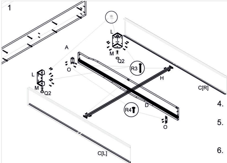
1. Взять спинку с прикрученным к ней опорным щитом и 2 опорных угла (L).
